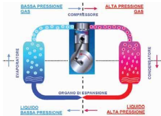
Figura 30: Schema del ciclo frigorifero
