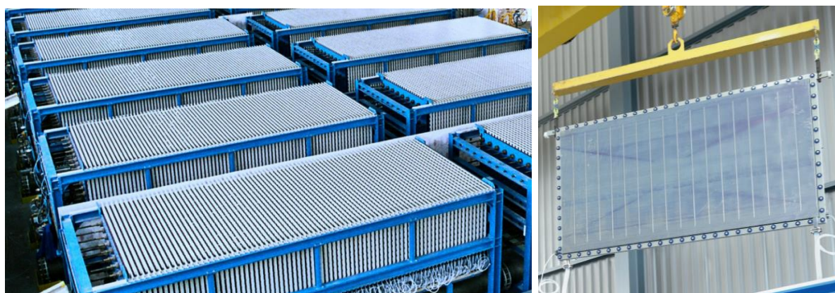
Figura 26 – Dettaglio delle celle elettrochimiche PEM
